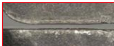
Die Kerbverschleißbeständigkeit in der Rostfrei-Bearbeitung konnte stark gesteigert werden.
